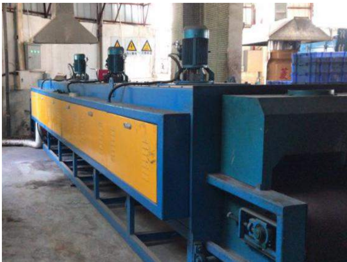
生产设备照片（网带回火炉）
